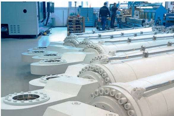
Monster-Zylinder zum Öffnen des Daches einer Eventhalle.
