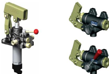
Handpumpen mit Doppelfekt-Aktivierung (Ölförderung beim Drücken und beim Ziehen des Hebels), mit Entwässerungshahn für Effekt- oder ohne Hahn für Notfall-Installationen.
