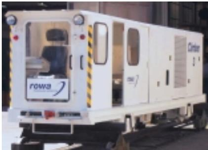
Der Antrieb ist ein Dieselmotor mit 174 kW, an dem eine Hydraulikpumpe im geschlossenen Kreislauf angeflanscht ist. Die Hydrokraft Axialkolbenpumpe treibt Radialkolbenmotoren der Marke Black-Bruin an. Auf die Radialkolbenmotoren
