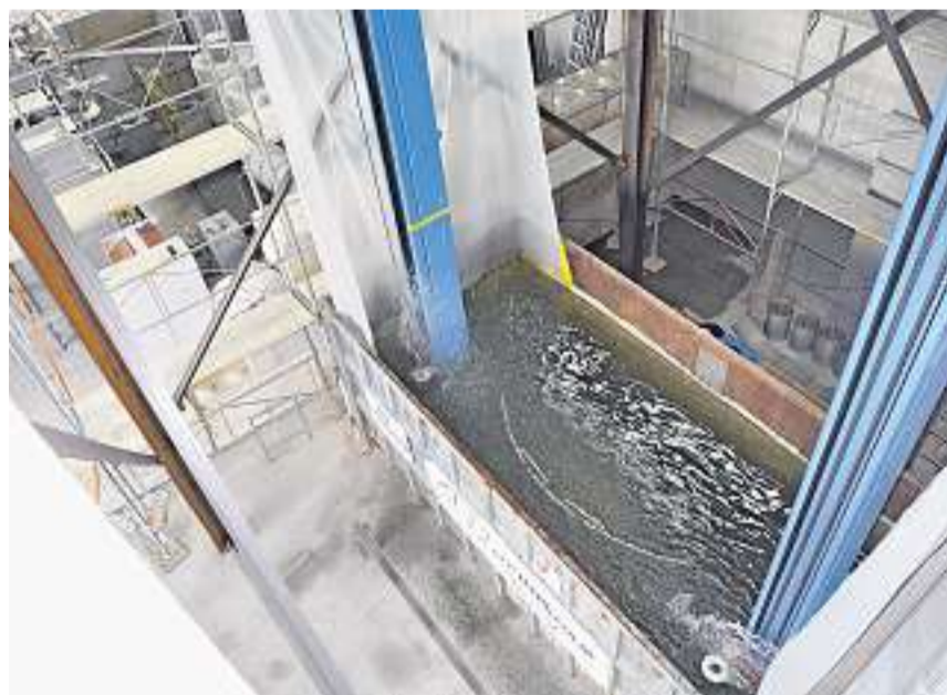
Die Portal-Diamantseilsäge wird im Wasserbecken getestet.
