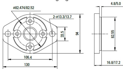
Code AA; SAE A; 2- $\varnothing$ 13.5;  $\varnothing$ 82.55x5 pilot
