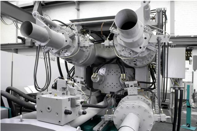
Für eine Druckguss-Maschinenreihe eines Kunden entwickelte die ATP Hydraulik Zylinderkomponenten für den Verfahrens- und Verriegelungsprozess.
