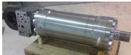
Bild: Zylinder mit integriertem Ventilblock
