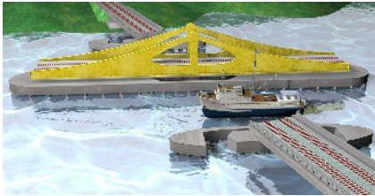
Bild: Prinzip der zweispurigen Eisenbahn-drehbrücke
