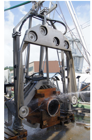
Seilsäge im Test bei ATP Hydraulik
