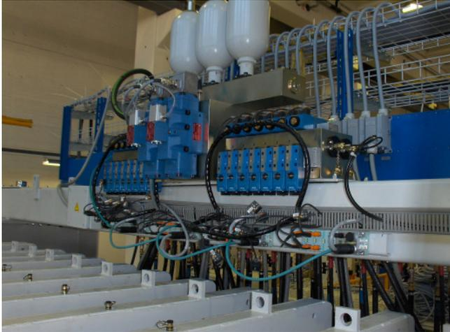
Gitterschweissmaschinen produzieren Armierungs- oder Bewehrungsgitter aus kalt oder warm gewalztem Draht. Die Gitterträger und räumlichen Armierungen finden ihren Einsatz im Hoch- und Tiefbau sowie im Strassen-, Tunnel- und Brückenbau auf der ganzen Welt. Die spezielle Leistung der ATP Hydraulik AG besteht in der Entwicklung eines Presszylinders, der eine Maschenbreite von 50 Millimetern erreicht und die Synchronisation verbessert.
